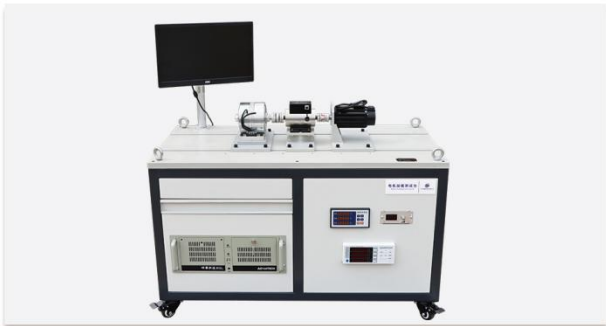
电机加载测试台 Motor loading test bench
