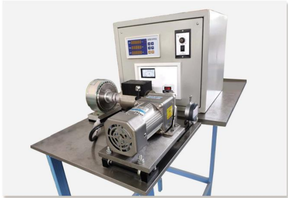
磁性齿轮加载测试台 Magnetic gear loading test bench
