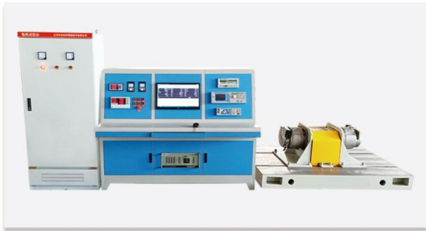
11KW电机对拖测试台 11KWMotor towing test bench
